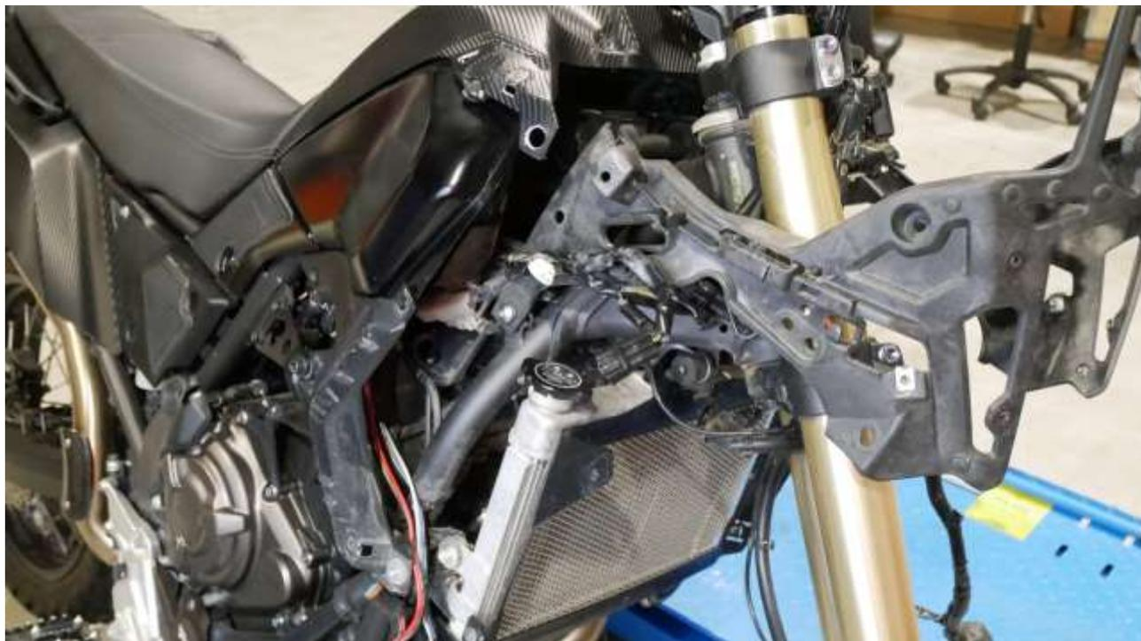
Procedere con il montaggio del primo componente, l'interfaccia che unisce il telaio della moto al nostro sistema torretta. In figura sotto è segnato in verde il lato alto, fare attenzione a non invertire il montaggio
