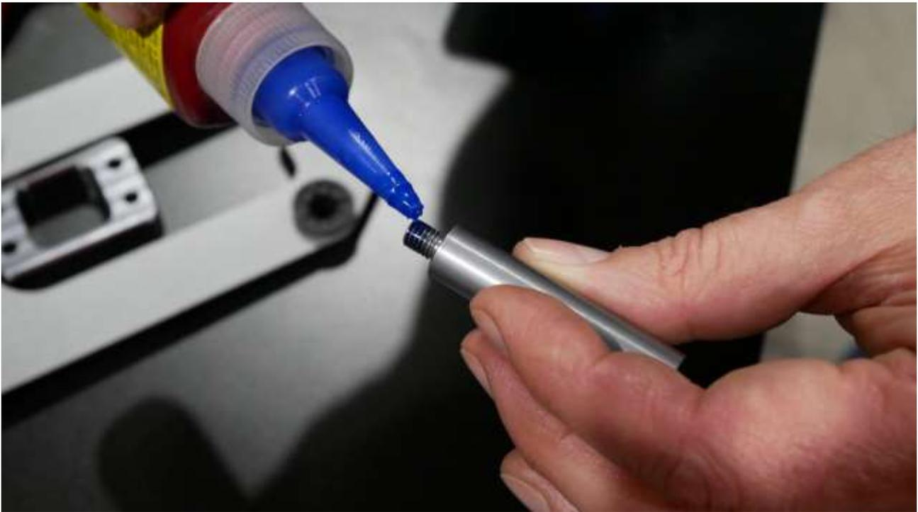
**Avvitarlo saldamente a mano fino in battuta, non utilizzare pinze o altri utensili per stringerlo!**
