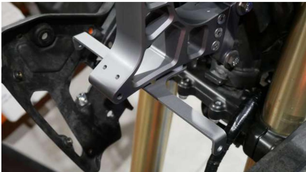
Procediamo al montaggio del supporto strumentazione nella parte superiore della torretta.
