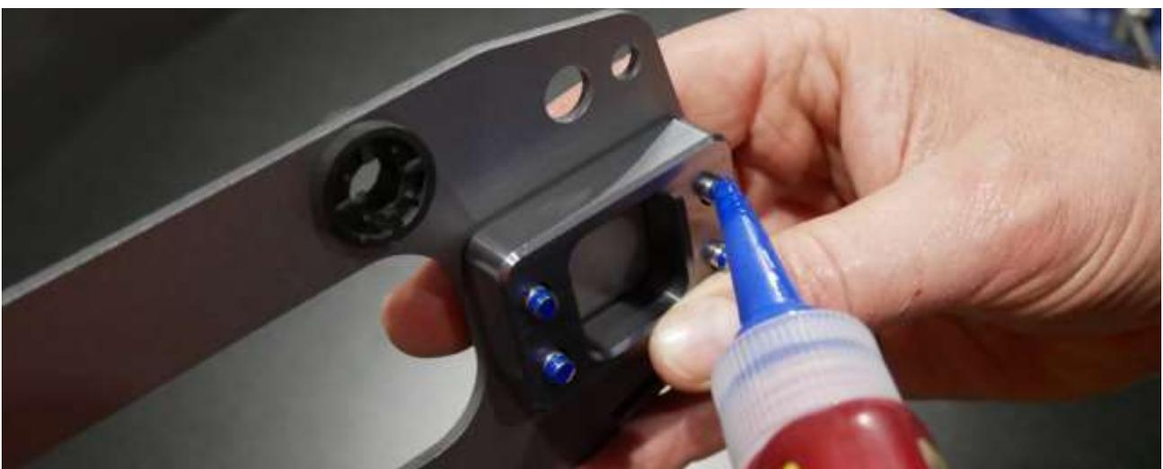
Fissare il supporto strumento, avendo cura di far passare prima all'interno il connettore strumento originale della moto (segnato in rosso). Serrare a mano le viti, non forzare.
