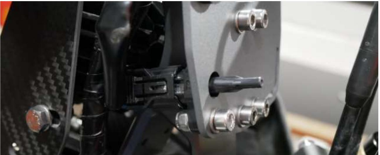
Consigliamo di applicare una fascetta al cavo strumento per mantenerlo in posizione
