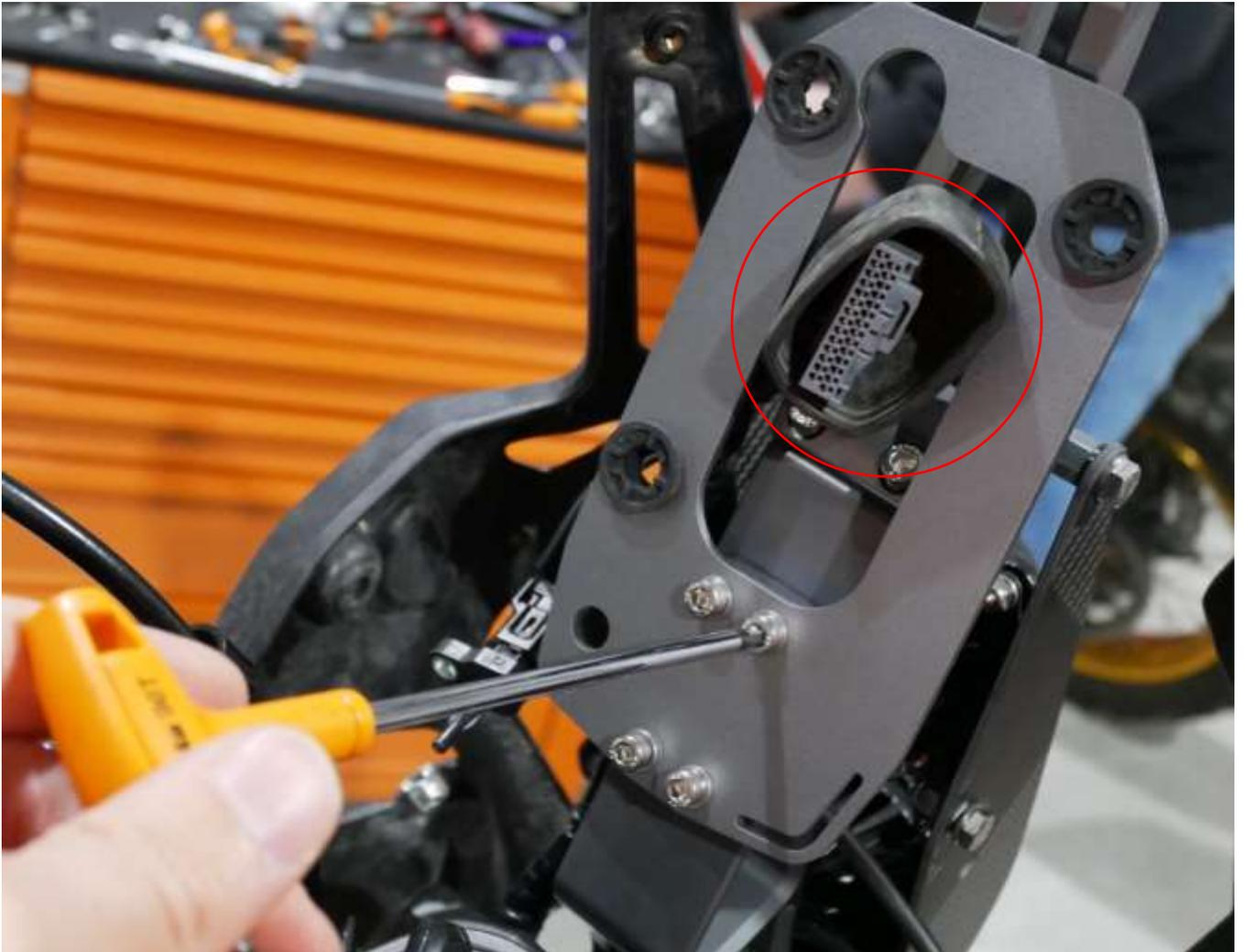
Con una vite M6 e dado autobloccante, procedere al fissaggio del sensore temperatura nell'apposito foro della piastra strumento come mostrato in foto
