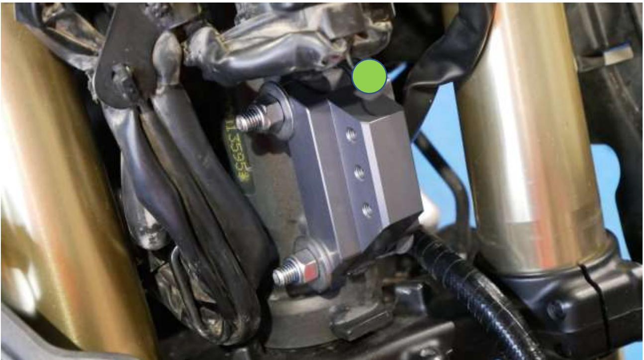
Serrare con forza le viti fino a quando l'interfaccia, per deformazione, non presenta più gioco sul telaio della moto
