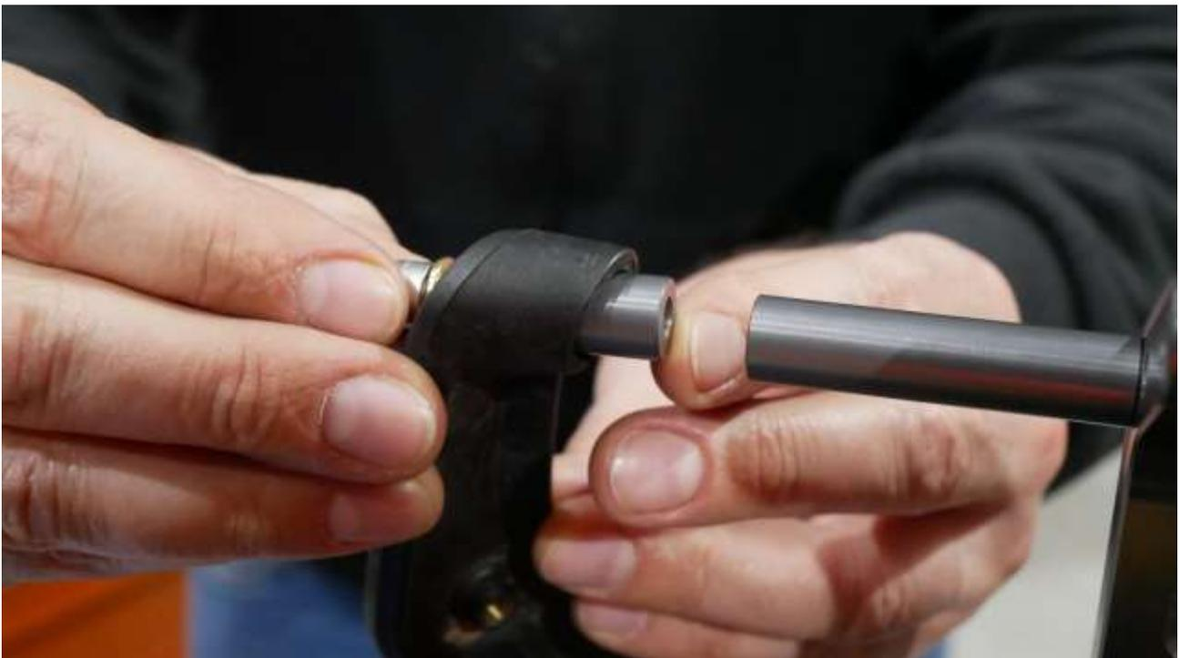
Stringere il tutto con una chiave. Non è necessario applicare una forza eccessiva. Una volta eseguita l'operazione, ripetere per l'altro lato. Ora le guance in composito della moto sono sostenute dalla torretta mediante la parte alta.
