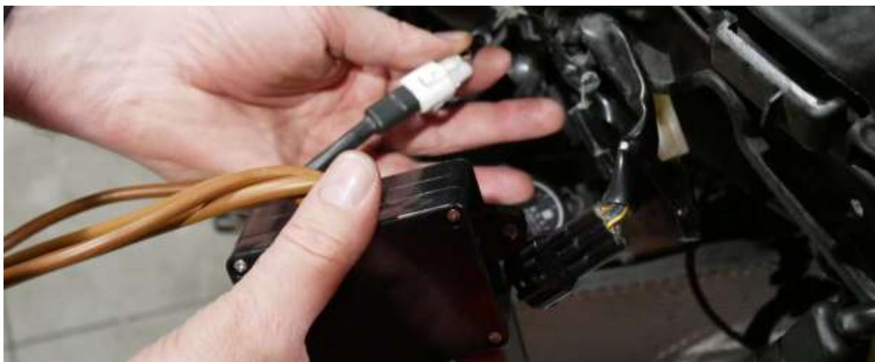
Fissare la centralina al telaio della moto nella zona indicata in figura tramite delle fascette in plastica di media grandezza. Non vi preoccupate per il calore del motore o per le vibrazioni in quanto la scatola elettronica è stata progettata per resistere senza alcun problema a quelle condizioni di lavoro e non subirà alcun danno.
