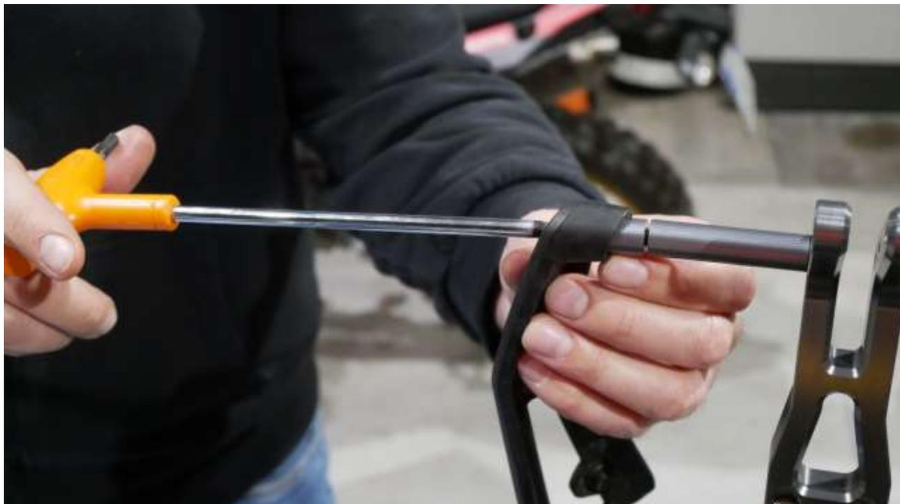
Eeguire ora il fissaggio del supporto carene inferiore. Potrebbe essere necessario un lieve adattamento della staffa di supporto mediante lo scorrimento all'interno delle apposite asole. Una volta trovata la posizione corretta, procedere al serraggio delle 2 viti utilizzando i dadi autobloccanti. Attenzione, non stringere eccessivamente per evitare danni alle plastiche.
